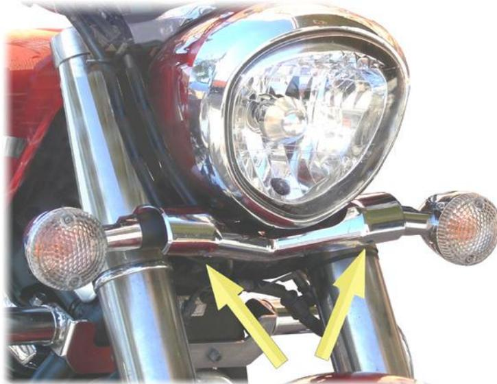
Nachdem Sie diese Schrauben entfernt haben, ziehen Sie die Verkleidung nach vorne, um sie von ihrem zentralen elastischen Anker zu lösen.
